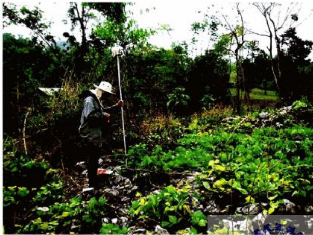
รูปที่ 20 การสำรวจวัดค่าความเข้มสนามแม่เหล็กโลกในภาคสนาม
