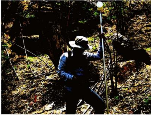
รูปที่ 19 การสำรวจวัดค่าความเข้มสนามแม่เหล็กโลกในภาคสนาม
