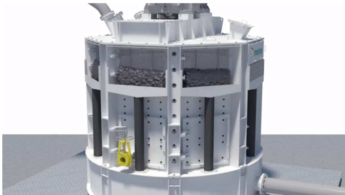
รูปที่ ๙ แสดงแร่ขนาดเล็กผสมน้ำและลูกบดจะถูกบีบให้ไหลผ่านตะแกรงดักลูกบด (Media Retention Screens) ที่อยู่ด้านบนรอบเครื่องบด Stirred Media Detritor (SMD) ของบริษัท Metso ภาพจาก https://www.youtube.com/watch?v=mKn7svN51U
