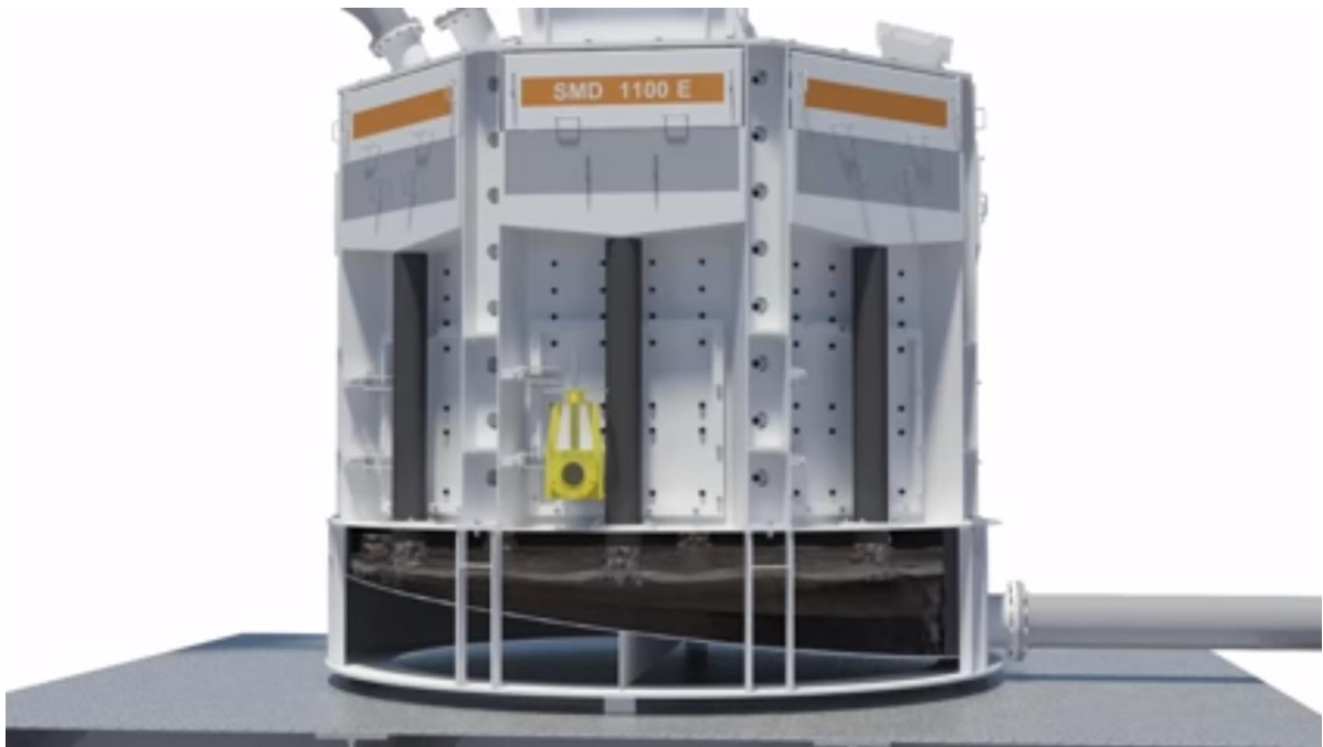
รูปที่ ๑๐ แสดงแร่ขนาดเล็กผสมน้ำไหลลงไปยังช่องพักแร่ (Product Launder) ที่อยู่ด้านล่างเครื่องบด Stirred Media Detritor (SMD) ของบริษัท Metso หลังจากนั้นจะเคลื่อนที่ออกจากเครื่องบดด้วยแรงโน้มถ่วงหรือเครื่องปั๊ม ภาพจาก https://www.youtube.com/watch?v=mKn7svN51U
