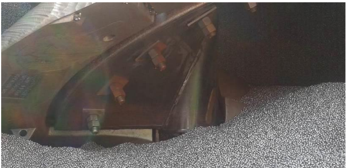
รูปที่ ๒ แสดงลูกบดที่ทำด้วยเหล็กภายในเครื่องบดแร่แบบเปียก Vertimill® ของบริษัท Metso
