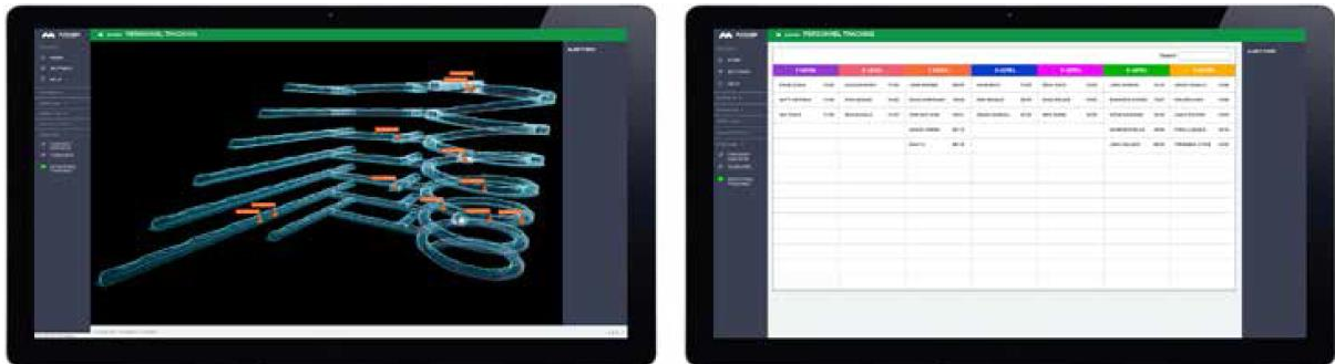
รูปที่ ๒ (ซ้าย) การแสดงตำแหน่งในอุโมงค์ที่พนักงานเหมืองแร่กำลังทำงานในโปรแกรม GuardIAN Dashboard (ขวา) รายชื่อพนักงานเหมืองแร่ที่ทำงานในแต่ละพื้นที่ของอุโมงค์ใต้ดินในโปรแกรม GuardIAN Dashboard ภาพจาก https://cdn.minearc.com/wp-content/uploads/Personnel-Tracking-Node_GuardIAN-Intelligence-Network_Brochure.pdf
