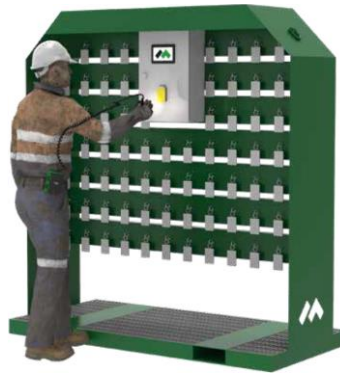
รูปที่ ๓ เครื่องตอกแบตเตอรี่ดิจิทัลในเหมืองใต้ดิน ภาพจาก https://cdn.minearc.com/wp-content/uploads/Personnel-Tracking-Node_GuardIAN-Intelligence-Network_Brochure.pdf
