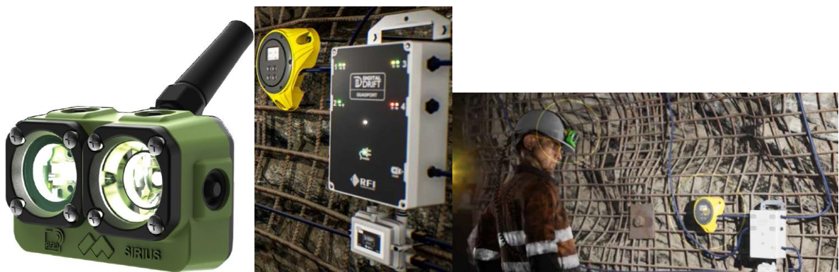
รูปที่ ๑ (บนซ้าย) เครื่องติดตามตัวในเมืองใต้ดิน คือชิปติดตามตัวบนไฟฉายติดหมวกนิรภัย (บนขวา) เครื่องตรวจวัดก๊าซประจำสถานี และ server (ล่าง) เครื่องติดตามตัวในเมืองใต้ดินขณะทำงาน
