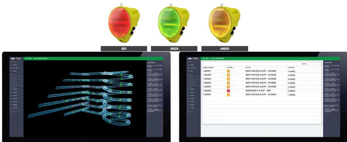
รูปที่ ๔ (บน) ไฟส่องสว่าง ๓ สี ได้แก่ สีแดง สีเขียวและสีเหลือง (ล่าง) ภาพและข้อมูลแสดงสีของไฟส่องสว่างในแต่ละพื้นที่ ของอุโมงค์ในโปรแกรม GuardIAN Dashboard ภาพจาก https://cdn.minearc.com/wp-content/uploads/Underground-Smart-Lighting-Node_GuardIAN-Intelligence-Network_Brochure.pdf
