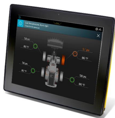
รูปที่ ๖ แสดงการแจ้งเตือนความดันลมยางล้อหน้าขวาอ่อนเกินไป ต้องเติมลมยาง
