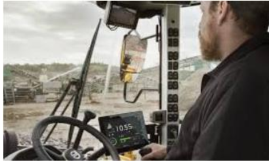
รูปที่ ๑ แสดง Load Assist โปรแกรมผู้ช่วยพนักงานขับรถดักล้อย่างของบริษัท Volvo ใน tablet ขนาด ๑๐ นิ้ว ภาพจาก https://www.volvoce.com/united-states/en-us/services/volvo-services/productivity-services/load-assist/
