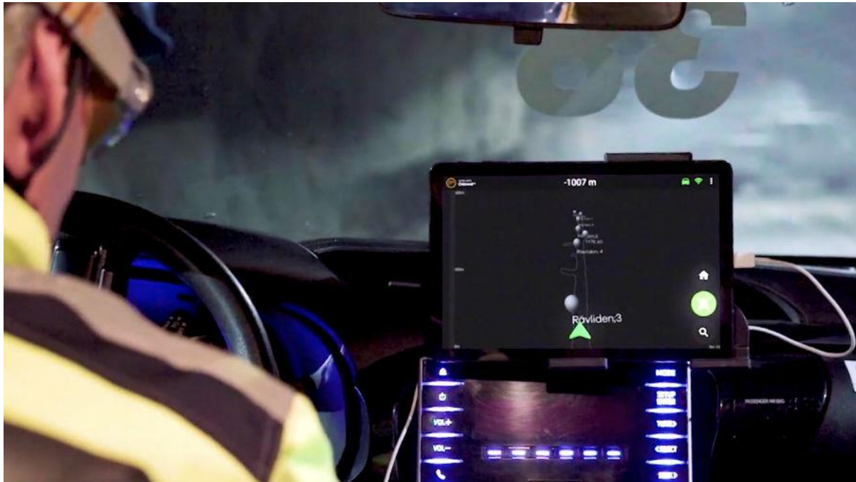
รูปที่ ๑ Mobilaris Onboard™ แสดงเส้นทางอุโมงค์และตำแหน่งรถที่ใช้เส้นทางร่วมกันแบบ real-time บน tablet ที่ติดไว้ในรถ ภาพจาก https://www.australianmining.com.au/whitepaper/mobilaris-new-product-are-set-to-revolutionize-the-mining-industry/
