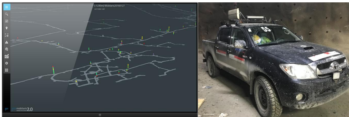
รูปที่ ๒ (ซ้าย) Mass Localization แสดงตำแหน่งของอุปกรณ์ที่ใช้บ่อยภายในเหมืองในโมเดลสามมิติของเหมืองใต้ดิน (ขวา) รถซ่อมบำรุงที่ติดสายอากาศหรือเครื่องอ่านไว้ม่านบน ภาพจาก https://mobilaris.se/mining-civil-engineering/mass-localization/
