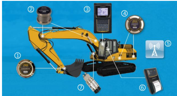
รูปที่ ๒ แสดงองค์ประกอบของระบบตรวจติดตามรถขุดของบริษัท Halomec ภาพจาก https://www.halomec.com/excavator-scales.html
