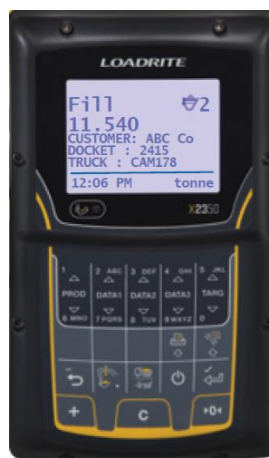
รูปที่ ๓ LOADRITE® X2350 แสดงสถานะบั้งก์ที่ตักแร่ครั้งที่สองหนัก ๑๑.๕๔๐ ตัน ใส่รถบรรทุกหมายเลข CAM178 ภาพจาก https://www.halomec.com/excavator-scales.html
