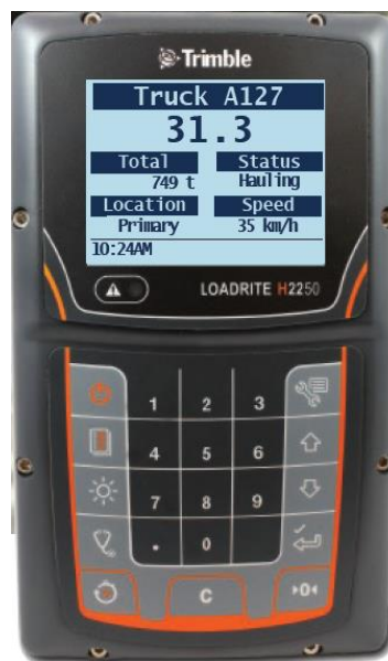
รูปที่ ๖ LOADRITE® H2250 แสดงรถบรรทุกหมายเลข A127 กำลังบรรทุกแร่หนัก ๓๑.๓ ตัน ด้วยความเร็ว ๓๕ กม./ชม. ตำแหน่งรถบรรทุกอยู่บริเวณ Primary และรถคันนี้บรรทุกแร่จนถึงปัจจุบันรวม ๗๔๙ ตัน ภาพจาก https://www.halomec.com/dump-truck-payload-monitoring.html
