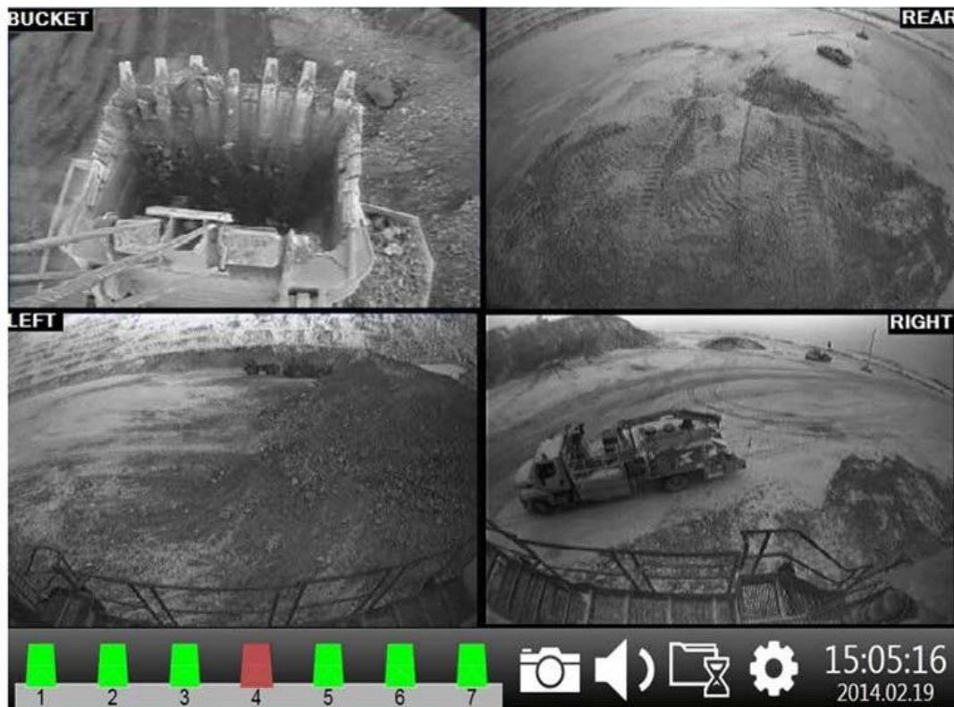
รูปที่ ๔ หน้าจอแสดงภาพพื้นบุงกีซีที่สี่หักและสภาพแวดล้อมรอบรถตักเสย ภาพจาก https://www.trysome.co.za/DynamicData/Product-Documents/B00904.1.pdf
