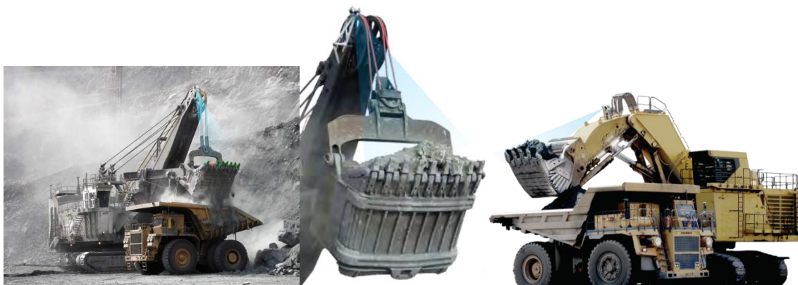
รูปที่ ๓ ตำแหน่งที่ติดตั้งกล้องวงจรปิดความหนาแน่นสูงพร้อมไฟ LED หรือกล้องตรวจจับความร้อนของรถตักเสียบ (ซ้ายและกลาง) แบบบังคับด้วยสายเคเบิล (ขวา) แบบบังคับด้วยกระบอกสูบไฮดรอลิก
