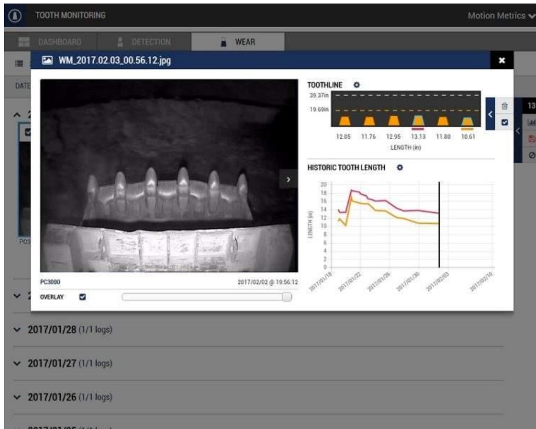
รูปที่ ๖ แสดงขนาดของฟันบั้งที่ตามระยะเวลาในโปรแกรม MetricsManager™Pro ภาพจาก https://www.mining-technology.com/contractors/communications/motion-metrics/
