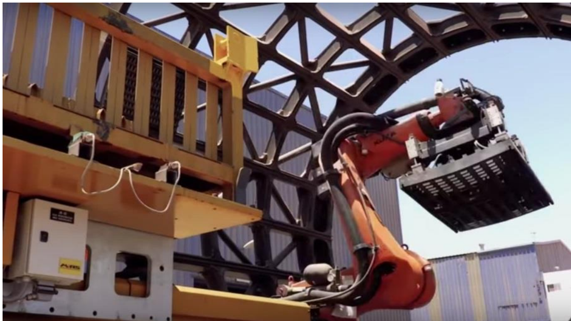
รูปที่ ๑๒ หุ่นยนต์ขณะทำการเปลี่ยนแผ่นตะแกรงของตะแกรงหมุน
