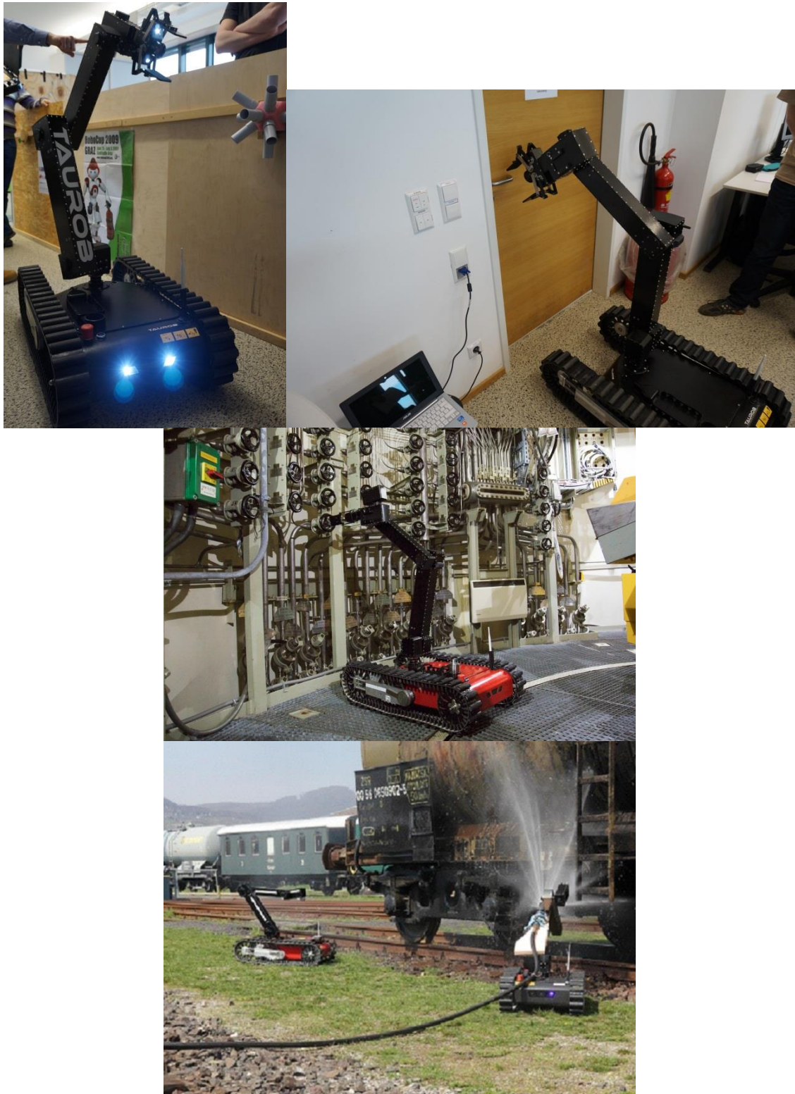
รูปที่ ๔ (บนซ้าย) การเปลี่ยนปลายแขนหุ่นยนต์ Taurob เป็นมือหนีบ (บนขวา) หุ่นยนต์ Taurob ขณะเปิดประตู (กลาง) หุ่นยนต์ Taurob ขณะเปิดปิดวาล์ว (ล่าง) หุ่นยนต์ Taurob ขณะจับสายฉีดน้ำในการทำความสะดวกสะอาดรถไฟ
