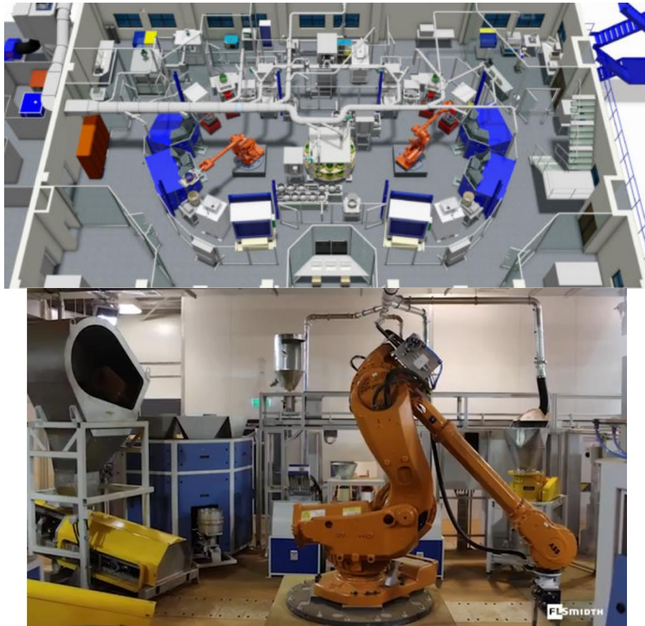
รูปที่ ๕ (บน) ผังห้องปฏิบัติการวิเคราะห์แร่เหล็กอัตโนมัติด้วยหุ่นยนต์ของบริษัท FLSmidth (ล่าง) หุ่นยนต์ในห้องปฏิบัติการ ภาพบนจาก https://im-mining.com/2020/05/04/flsmidth-automated-lab-wins-contract-extension-saldanha-iron-ore-terminal/ ภาพล่างจาก https://www.flsmidth.com/en-gb/products/iron-ore-laboratory-automation
