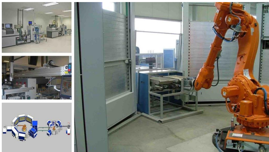
รูปที่ ๖ แสดงผังและภาพห้องปฏิบัติการวิเคราะห์โลหะที่ไม่ใช่เหล็กอัตโนมัติด้วยหุ่นยนต์ของบริษัท FLSmidth ภาพจาก https://www.flsmidth.com/en-gb/products/non-ferrous-metal-laboratory-automation
