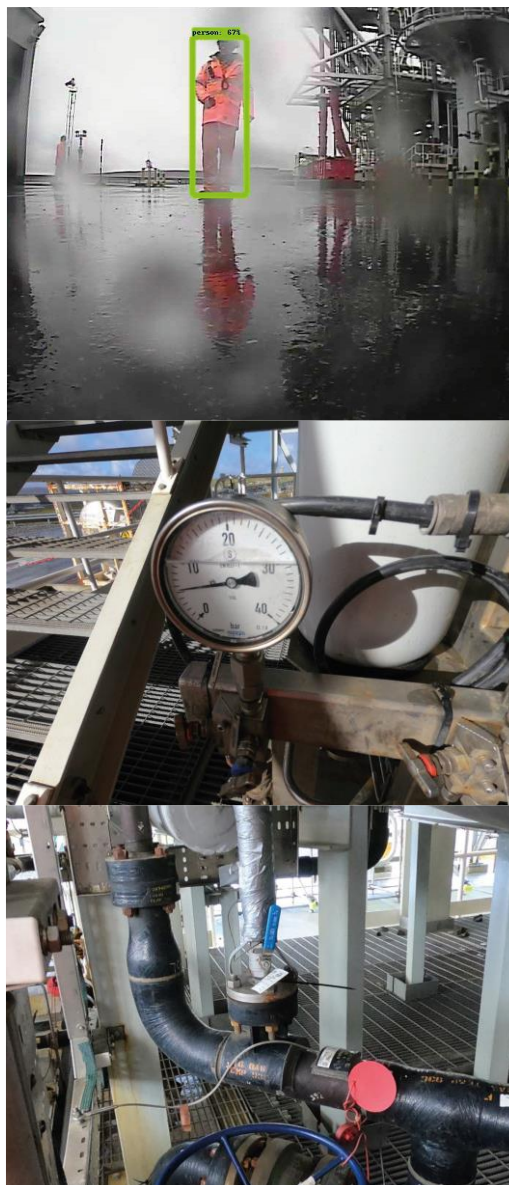
รูปที่ ๓ ความสามารถของหุ่นยนต์ Taurob (บน) ตรวจจับสิ่งกีดขวาง (กลาง) อ่านมาตรวัด (ล่าง) ตรวจวัดการสั่นสะเทือน ภาพจาก https://taurob.com/wp-content/uploads/2020/08/Technical-Product-Sheet.pdf
