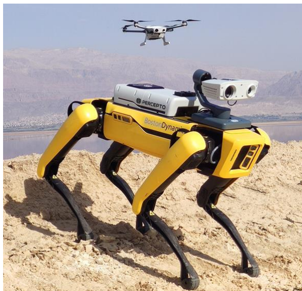
รูปที่ ๖ โดรนตรวจการและหุ่นยนต์สุนัขที่บริษัท Percepto ใช้ในการตรวจโรงเต่งแร่ ICL Dead Sea ภาพจาก https://www.youtube.com/watch?v=ESW8do5NLr0
