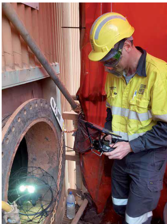
รูปที่ ๒ โดรน Elios ที่มีลักษณะพิเศษคือมีตาข่ายทรงกลมที่ทำจากคาร์บอนไฟเบอร์ล้อมรอบตัวโดรนไว้
