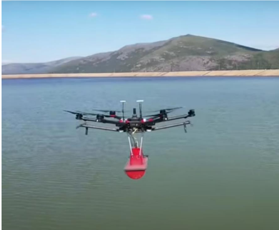
รูปที่ ๙ โดรนหยั่งความลึกของน้ำด้วยสัญญาณเรดาร์ จะต้องบินให้เสาอากาศเรดาร์อยู่เหนือน้ำตลอดเวลา ภาพจาก https://www.youtube.com/watch?v=x-12rYBfiQ8
