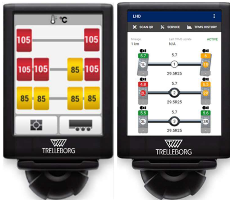
รูปที่ ๖ แสดงข้อมูลของยางแต่ละเส้น (ซ้าย) อุณหภูมิ (หน่วยองศาเซลเซียส) (ขวา) ความดัน (หน่วยบาร์) ภาพจาก https://www.trelleborg.com/en/wheels/tools-and-resources/construction-tires/trelleborg-tpms
