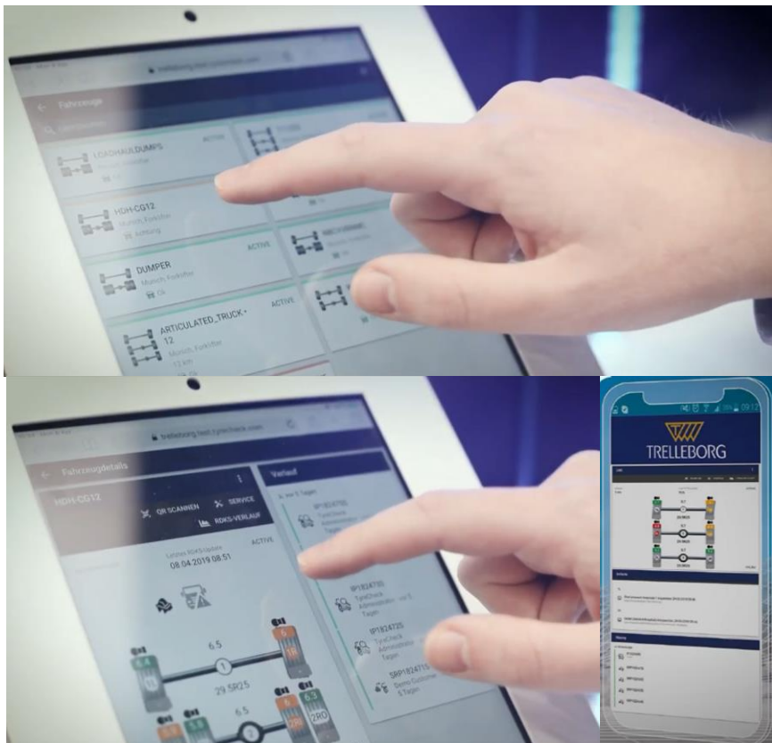
รูปที่ ๕ (บน) ภาพรวมของระบบตรวจวัดอุณหภูมิและความดันยางของรถยนต์ทั้งหมดภายในเหมืองที่แสดงใน tablet (ล่างซ้าย) ข้อมูลการตรวจวัดอุณหภูมิและความดันยางทุกเส้นของรถยนต์ที่แสดงใน tablet (ล่างขวา) ข้อมูลการตรวจวัดที่แสดงในโทรศัพท์มือถือ
