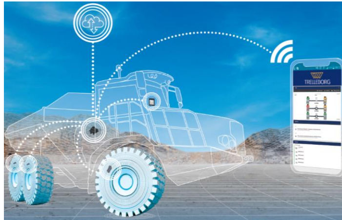
รูปที่ ๑ แสดงระบบตรวจวัดอุณหภูมิและความดันยางของรถยนต์ (Temperature and Pressure Measurement System, TPMS) ของบริษัท Trelleborg
