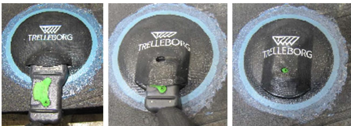
รูปที่ ๓ การติดตั้งแผ่นปะยางที่ด้านในของยางนอกและกรีดเป็นกระเปาะพร้อมเจาะรูเปิด หลังจากนั้นนำเซ็นเซอร์ใส่ในกระเปาะ โดยให้หัวเซ็นเซอร์อยู่ตรงรูเปิดเพื่อให้เซ็นเซอร์สัมผัสยางในของรถยนต์
