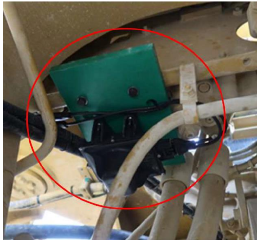
รูปที่ ๔ (ซ้าย) router ที่ใช้รับข้อมูลจากเซ็นเซอร์และส่งข้อมูลไปยังระบบ cloud (ขวา) การติดตั้ง router ไว้ใต้ห้องโดยสาร ภาพจาก https://www.trelleborg.com/en/wheels/tools-and-resources/construction-tires/trelleborg-tpms
