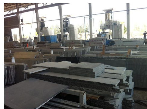
รูปภาพบน ลักษณะของบล็อกหิน ที่ได้จากการทำเหมือง รูปภาพล่าง โรงงานตัดหินเพื่อการแปรรูป บล็อกหินให้เป็นแผ่น
