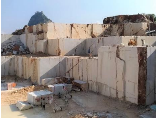
รูปภาพ สภาพหน้าเหมืองหินอ่อน ซึ่งเกิดจากการ ทำเหมืองด้วยเครื่องตัดหินแบบลวดเพชร
