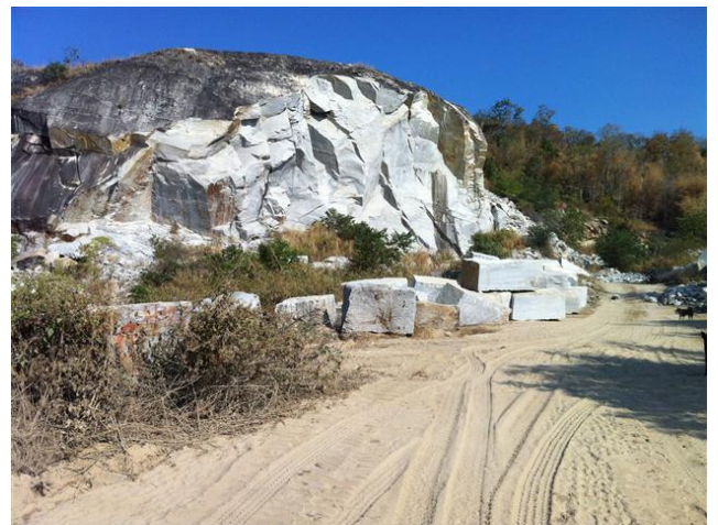
รูปภาพบน แสดงการเจาะหินและการแยกหินด้วยลิ้ม รูปภาพล่าง การเหมืองหินประดับชนิดหินแกรนิต ในอดีตที่ใช้การระเบิดร่วมกับลิ้มตอกเพื่อแยกหินออก
