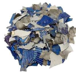
รูปที่ ๘ แผ่นซิลิกอนที่ได้จากการคัดแยก
