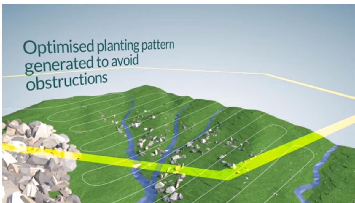
รูปที่ ๓ การออกแบบเส้นทางการบินของโดรน (เส้นสีขาว) เพื่อหลีกเลี่ยงสิ่งกีดขวางต่าง ๆ ภาพจาก https://impakter.com/biocarbon-engineering/
