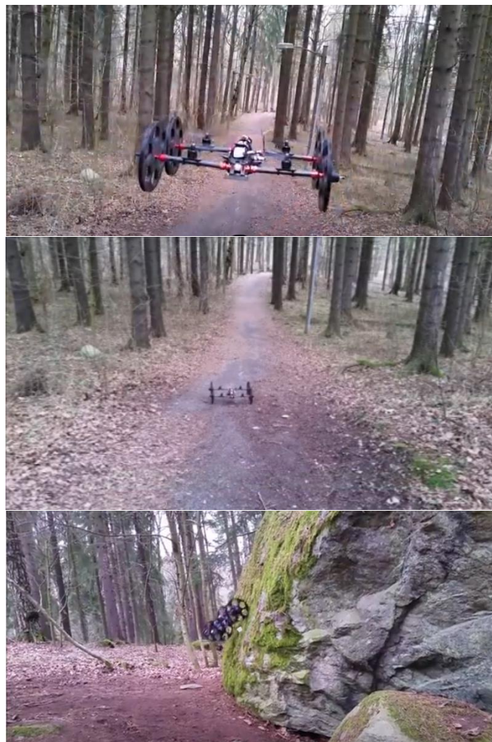
รูปที่ ๗ โดรนสี่ล้อ TILT Ranger ของบริษัท Inkonova ที่สามารถบิน วิ่งและปีน ซึ่งเหมาะสำหรับการใช้งานในเหมืองใต้ดิน
