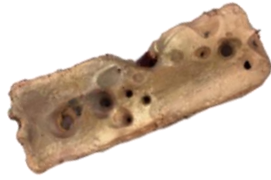
รูปที่ ๕ การหลอมแถบไฟฟ้า เพื่อผลิตเป็น Copper Anode
