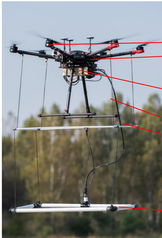
รูปที่ ๑ แสดงโดรนตรวจจับวัตถุที่เป็นโลหะใต้ผิวดินของบริษัท SPH Engineering ภาพจาก https://integrated.ugcs.com/files/metal-detector/drone-integrated-metal-detector.pdf
