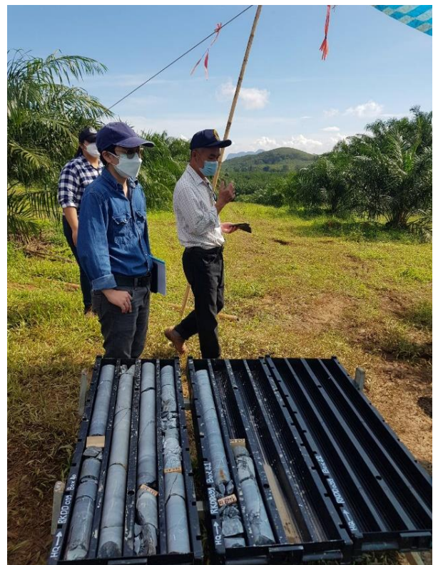
การเจาะสำรวจบริเวณพื้นที่แหล่งแร่เรืองเกียรติ และแท่งตัวอย่างแร่และหินที่ได้จากการเจาะสำรวจ
