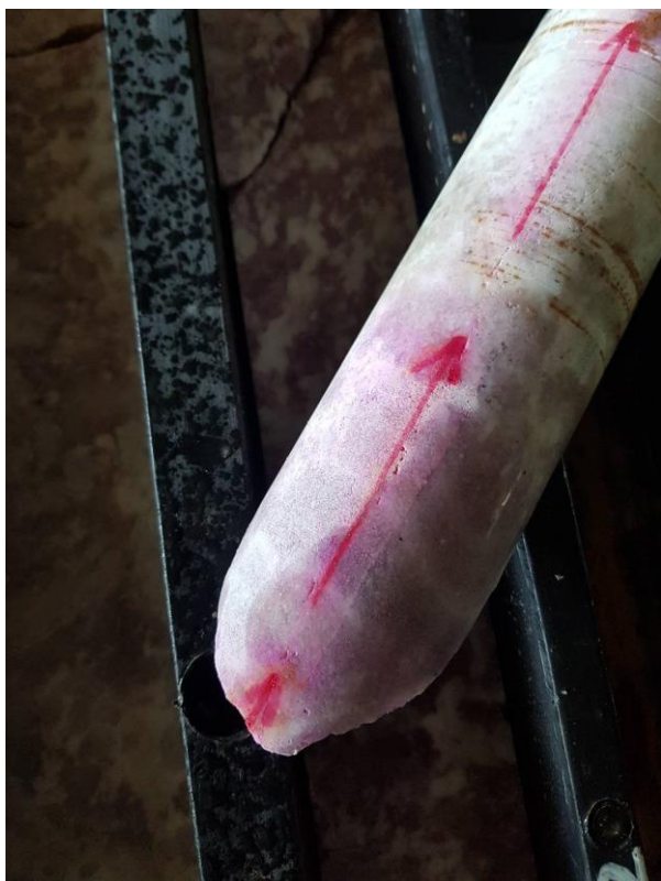
แท่งตัวอย่างจากสายเพกมาไทต์-เลพิโดไลต์ สีม่วงอมชมพู ที่ได้จากการเจาะสำรวจ
