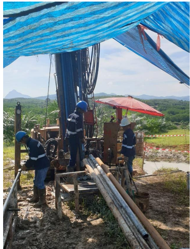
การเจาะสำรวจบริเวณพื้นที่แหล่งแร่เรืองเกียรติ และแท่งตัวอย่างแร่และหินที่ได้จากการเจาะสำรวจ
