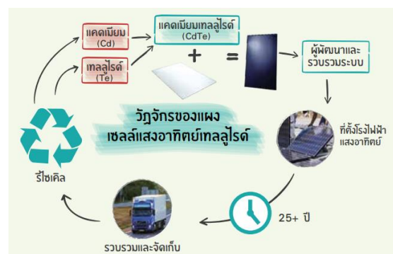
รูปที่ ๖ วงจรของแผงเซลล์แสงอาทิตย์เทลลูไรด์
