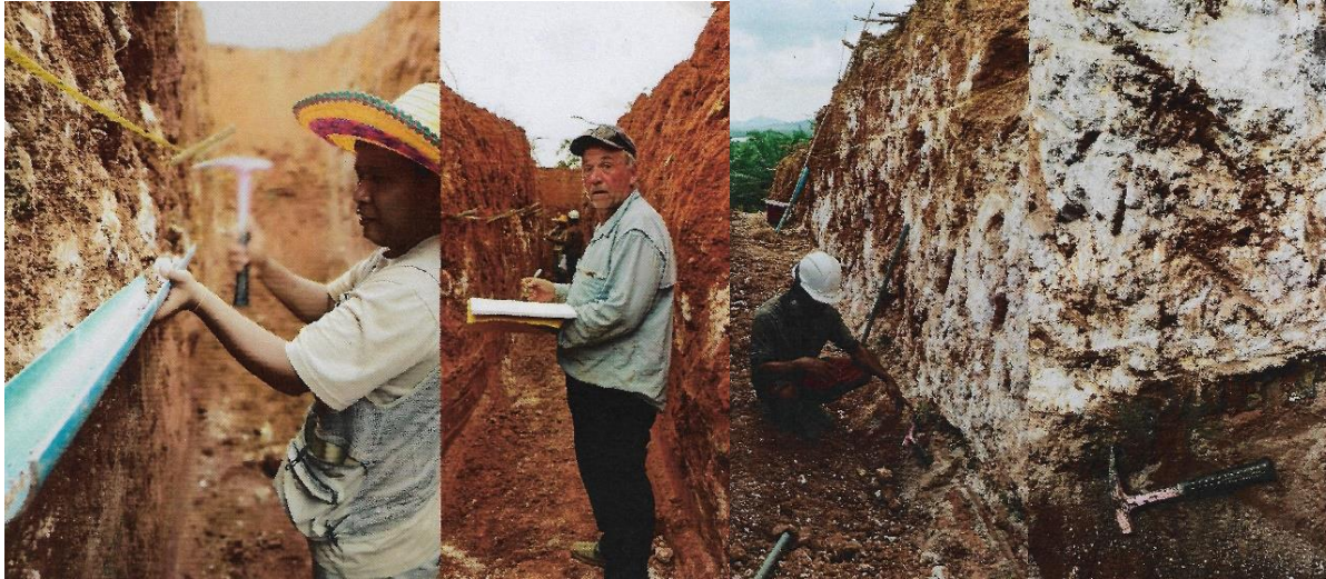
การตรวจสอบสำรวจ การบันทึกข้อมูล และการเก็บตัวอย่างเพื่อส่งวิเคราะห์ พบสายเพกมาไทต์หนาแน่นในหลายบริเวณ
