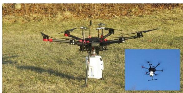
รูปที่ ๑ โดรนสำรวจแร่ด้วยเซนเซอร์ถ่ายภาพไฮเปอร์สเปกตรัมของบริษัท Headwall Photonics
