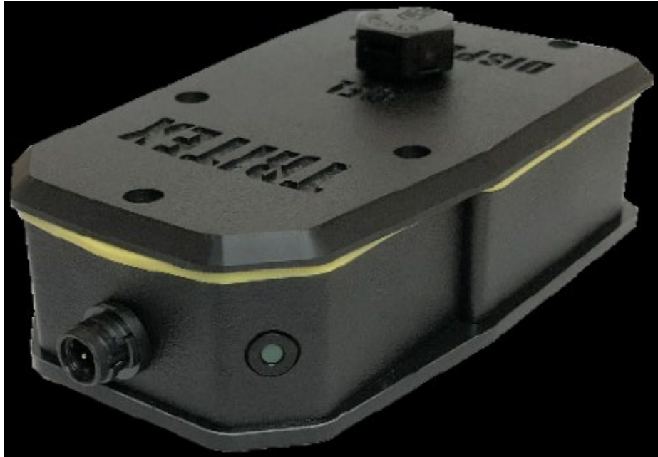
รูปที่ ๔ เครื่องจ่ายเจลที่ติดตั้งอยู่ด้านล่างของโดรนของบริษัท Tritex NDT
