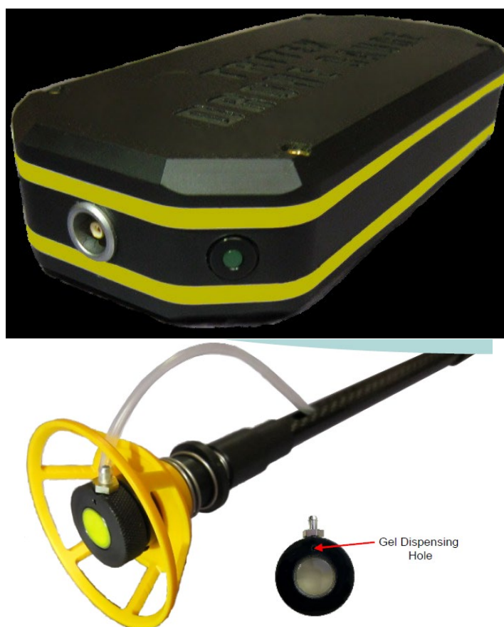
รูปที่ ๓ (บน) เครื่องวัดความหนาของพื้นผิวโลหะ (ล่าง) ก้านต่อหัววัด กรวยยึดหัววัด และหัววัดที่มีรูระบายเจลด้านบน ภาพจาก https://www.tritexndt.com/wp-content/uploads/2020/11/Drone-Thickness-Gauge-Multigauge-6000.pdf
