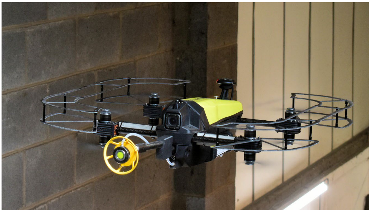
รูปที่ ๒ แสดงโดรนตรวจวัดการสึกหรอของพื้นผิวโลหะของบริษัท Tritex NDT ภาพจาก https://www.tritexndt.com/wp-content/uploads/2020/11/Drone-Thickness-Gauge-Multigauge-6000.pdf
