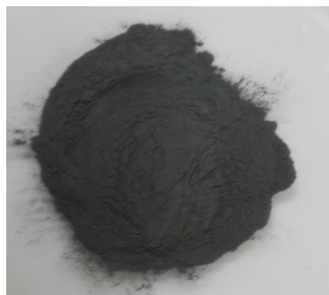
ภาพ ฝุ่นจากเตาหลอมเหล็กที่มีสังกะสีเป็นองค์ประกอบ
