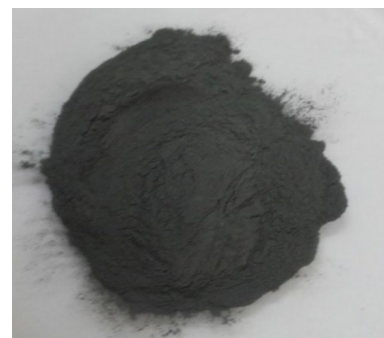
ภาพ ฝุ่นจากเตาหลอมเหล็กที่มีสังกะสีเป็นองค์ประกอบ
