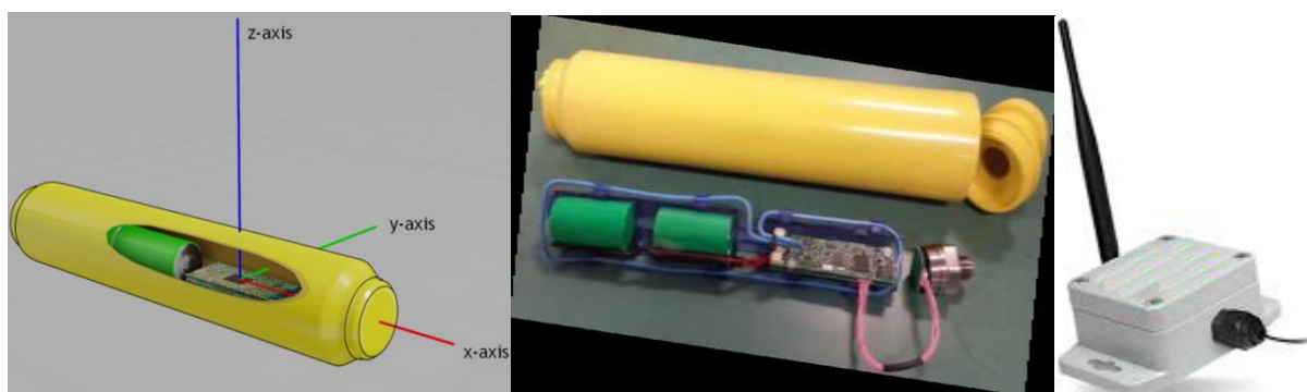
รูปที่ ๑ (ซ้ายและกลาง) อุปกรณ์ตรวจวัดความเอียงหรือ Tilt Marker ของบริษัท Elexon Mining ภายในประกอบด้วย เซ็นเซอร์ตรวจวัดความเอียงแบบสามแกนและแบตเตอรี่ (ขวา) เครื่องรับสัญญาณเซ็นเซอร์
