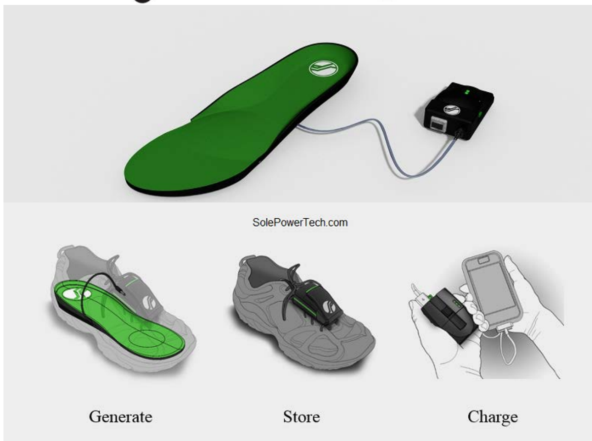
รูปที่ ๖ (บน) รองเท้าอัจฉริยะ (กลาง) การติดตั้งอุปกรณ์ตรวจจับตำแหน่งกับแผ่นรองเท้า (ล่าง) แสดงตำแหน่งแผ่นรองเท้าและอุปกรณ์ตรวจจับตำแหน่ง รวมถึงการชาร์จอุปกรณ์ตรวจจับตำแหน่งด้วยโทรศัพท์มือถือ ภาพจาก Camas (2020)
