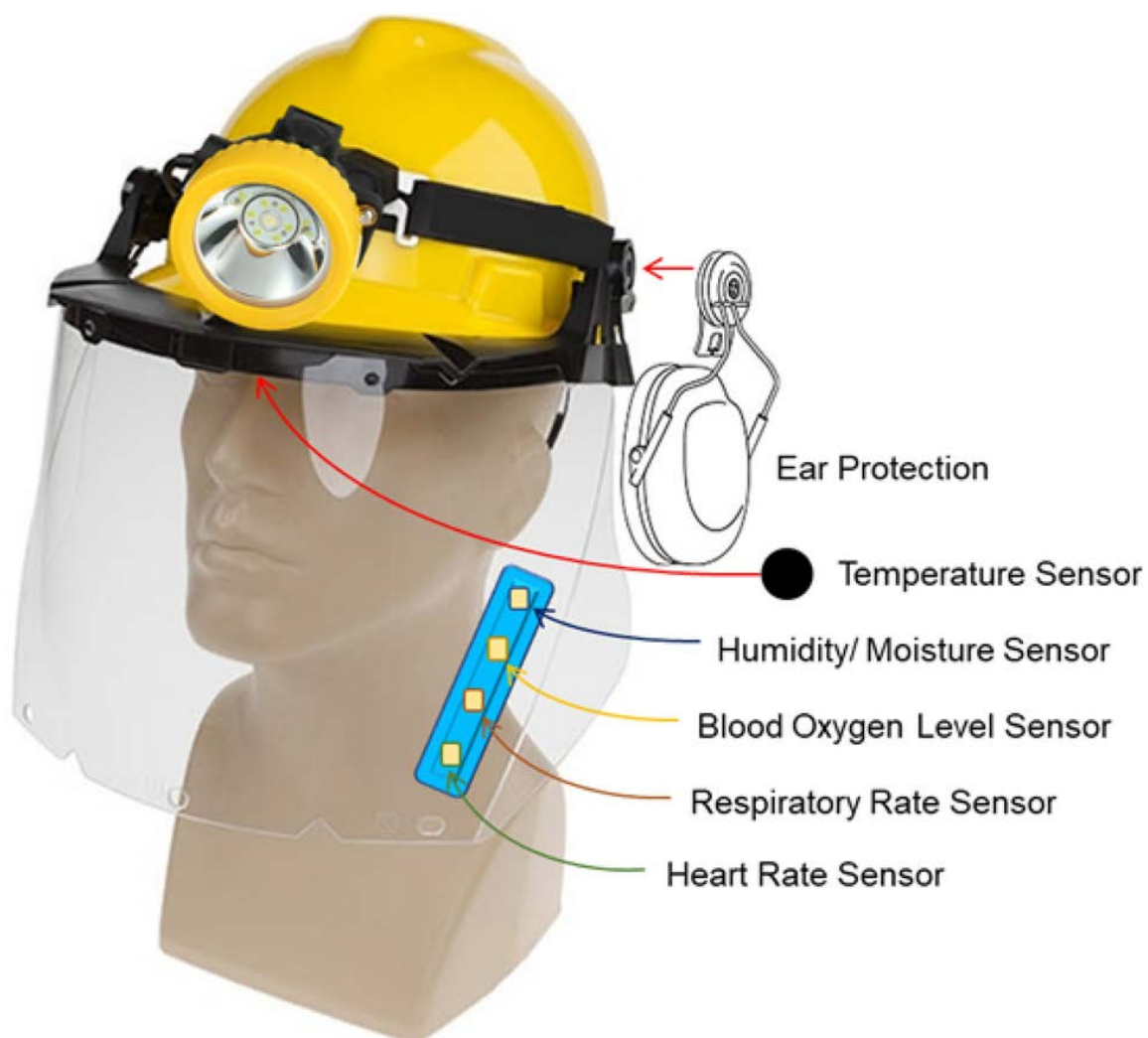
รูปที่ ๕ โมเดล Face Shield อัจฉริยะประกอบด้วยเซ็นเซอร์ตรวจวัดอุณหภูมิร่างกาย ความชื้นในอากาศ อัตราการหายใจ อัตราการเต้นของหัวใจ และระดับออกซิเจนในเลือด โดยแสดงสถานะผู้สวม Face Shield ผ่านแถบไฟ LED ที่อยู่ด้านหน้า ภาพจาก Das (2020)
