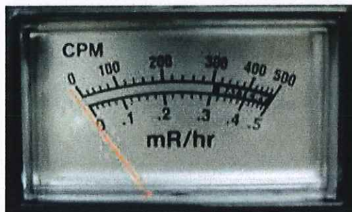
รูปที่ ๒ แสดงหน้าปัดเครื่องวัดรังสีชนิดไกเกอร์มูลเลอร์ (ซ้าย) แบบเข็ม (ขวา) แบบดิจิทัล
