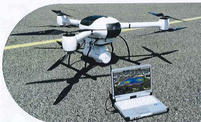
รูปที่ ๕ แสดงโดรนตรวจวัดรังสี NuEM Drones G ของบริษัท Nuviattech Instruments และผลตรวจวัดที่สถานีภาคพื้นดิน
