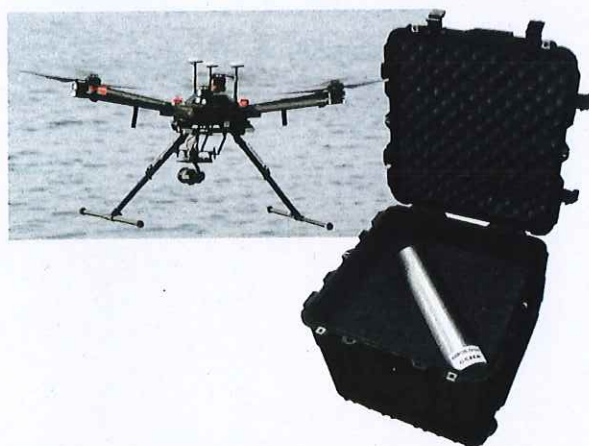
รูปที่ ๘ (ซ้าย) GAMON Drone ของบริษัท CAEN (ขวา) หัววัดรังสีชนิดเรืองแสงวามมีให้เลือก ๓ ชนิด NaI(Tl) CeBr 3 หรือ LaBr 3 (Ce) ภาพจาก https://www.caen.it/products/gamon-drone/
