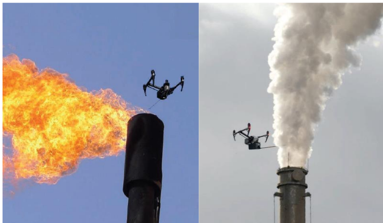
รูปที่ ๒ แสดงการเก็บตัวอย่างอากาศและควันจากปล่องควันผ่านโพรบของโดรนตรวจวัดคุณภาพอากาศ ภาพจาก https://scentroid.com/wp-content/uploads/2020/08/DR2000-Product-Brochure.pdf
