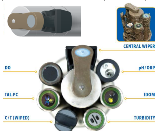
รูปที่ ๗ แสดงเซ็นเซอร์ดิจิทัลสูงสุด ๖ ตัวและแปรงทำความสะอาดภายในอุปกรณ์ตรวจวัดคุณภาพน้ำ EXO2s ของบริษัท Xylem
