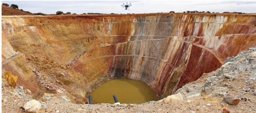
รูปที่ ๒ แสดงการใช้โดรน HydroDrone เก็บตัวอย่างน้ำในบ่อเหมืองของบริษัท MWES ประเทศออสเตรเลีย
