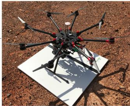
รูปที่ ๓ (ซ้ายและกลาง) โดรน HydroDrone ของบริษัท MWES ประเทศออสเตรเลีย (ขวา) ตัวอย่างน้ำในบ่อเหมือง
