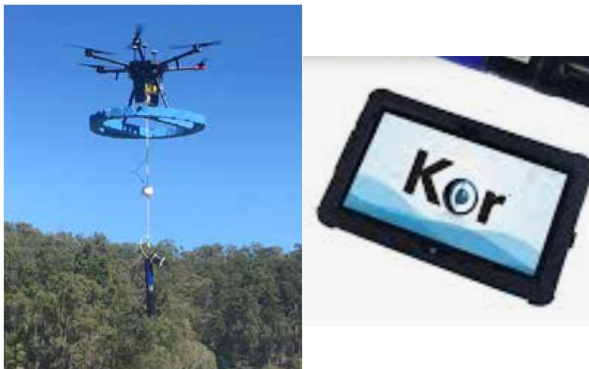
รูปที่ ๕ (ซ้าย) โดรนขณะบรรทุกอุปกรณ์ตรวจวัดคุณภาพน้ำอัตโนมัติ EXO2s (ขวา) โปรแกรม KorExo ที่ใช้ควบคุมอุปกรณ์ตรวจวัดคุณภาพน้ำอัตโนมัติ EXO2s ของบริษัท Xylem
