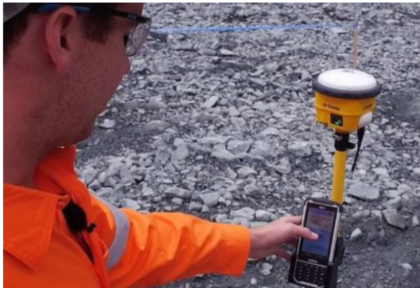
รูปที่ ๑๐ แสดงการตรวจวัดตำแหน่ง BMM โดยพนักงานเหมืองแร่ นำเครื่องไปตรวจวัดก่อนการระเบิด ภาพจาก https://blastmovement.com/blast-monitoring/
