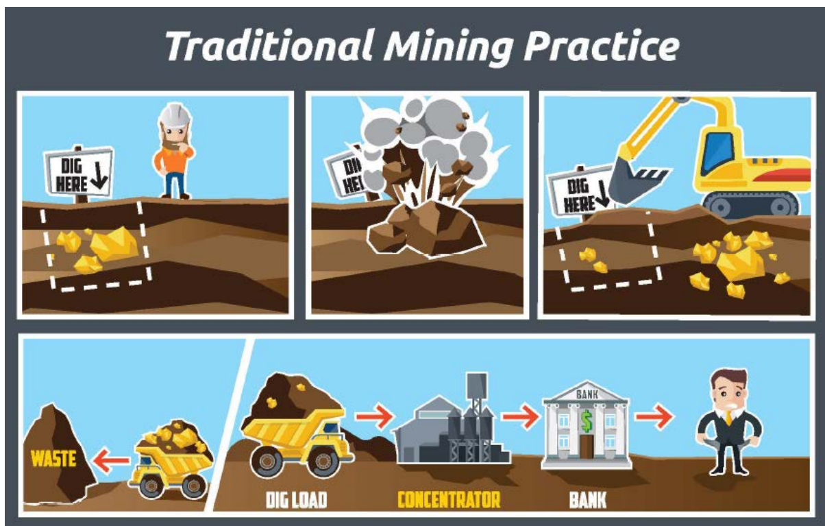
รูปที่ ๕ แสดงการระเบิดแบบเดิมที่ไม่มีการระบุตำแหน่งสายแร่ (Ore Body) ทำให้ผลกำไรน้อย ภาพจาก https://blastmovement.com/blast-monitoring/
