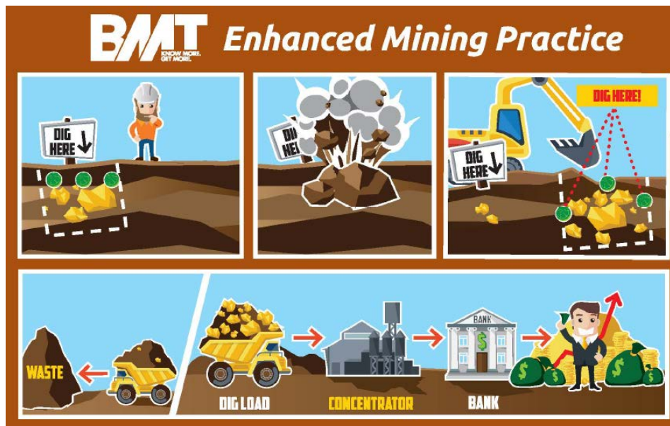
รูปที่ ๖ แสดงการระเบิดแบบใหม่ที่มีการระบุตำแหน่งสายแร่ (Ore Body) ด้วย Blast Movement Monitor (BMM) ทำให้ผลกำไรมาก ภาพจาก https://blastmovement.com/blast-monitoring/
