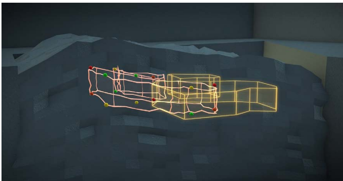
รูปที่ ๑๑ แสดงตำแหน่งสายแร่หลังการระเบิดด้วยโปรแกรม BMM Explorer ภาพจาก https://blastmovement.com/blast-monitoring/
