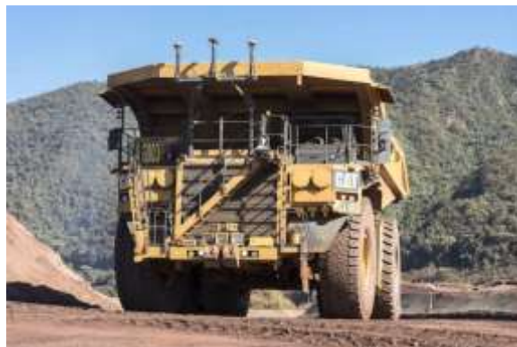
รถบรรทุกแร่ระบบขับเคลื่อนด้วยตัวเองขนาด 240 ตัน
