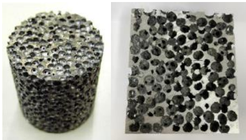
รูปที่ ๕ ตัวอย่างโฟมโลหะที่ได้จากกระบวนการผลิตการใช้วัสดุสร้างโพรงอากาศ
