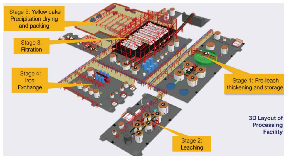
รูปที่ ๑ แสดงขั้นตอนการผลิตเค้กเหลือง (Yellow cake หรือ triuranium octoxide ( U_3O_8 )) ในโรงประกอบโลหกรรม ภาพจาก https://auraenergy.com.au/wp-content/uploads/2025/02/Tiris-fact-sheet-FY25-web.pdf
