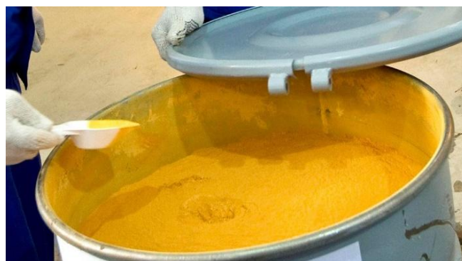
รูปที่ ๒ เค้กเหลือง (Yellow cake หรือ triuranium octoxide ( U_3O_8 )) ในถังบรรจุภัณฑ์ตามข้อกำหนดความปลอดภัยสากล ภาพจาก https://www.facebook.com/235052433674400/photos/379476359232006/
