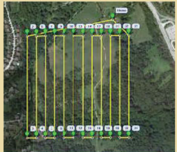
รูปที่ 3 ตัวอย่างแนวนบินถ่ายภาพเพื่องานสำรวจรังวัดด้วย UAV
