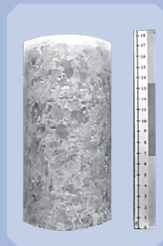
ภาพที่ 1 แท่งตัวอย่างเกลือหิน ซึ่งได้จากการเจาะสำรวจ
