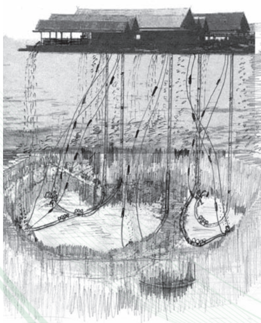
รูปที่ 4 แพไม้ไผ่ดูดแร่ใช้จอบเก็บกู้แร่
