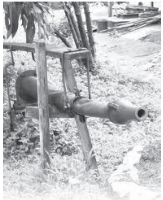
รูปที่ 10 ลักษณะหัวฉีดของเหมืองฉีด
