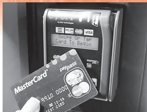
ภาพแสดงป้ายอิเล็กทรอนิกส์ (RFID Tag) ในรูปแบบต่าง ๆ และตัวอ่านข้อมูล (Reader)
