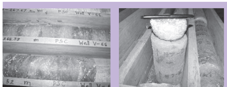
รูปที่ 2 ตัวอย่างแท่งเกลือหินของบริษัท เกลือพิมาย จำกัด ซึ่งได้จากการเจาะสำรวจที่ระดับความลึกประมาณ 250 เมตร
