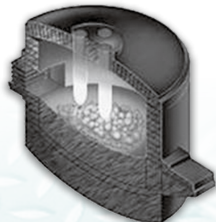
รูปที่ 2 เตาหลอมเศษเหล็กแบบอาร์คไฟฟ้า และสแลกที่เกิดขึ้นในเตา ที่มา : www.airproductsafrica.co.za
