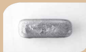
โลหะทองแดงที่ได้จากการแยกสกัดแผงวงจรอิเล็กทรอนิกส์
