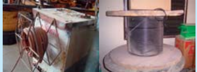
การจัดเก็บสายไฟอย่างถูกต้องเหมาะสมและสะดวกต่อการใช้งาน
