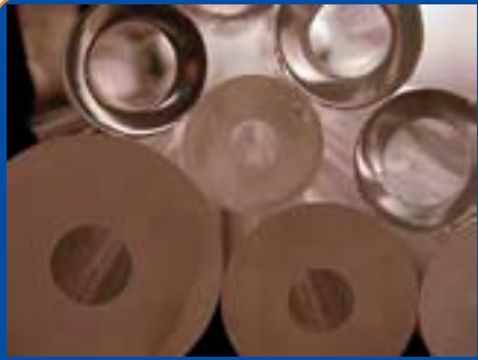
รูปที่ 3 ตัวอย่างผลิตภัณฑ์แก้วจากกระบวนการโซล-เจล
