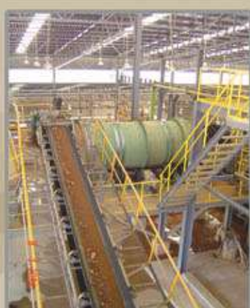
การบดขยี้แร่เพื่อส่งไปแต่งแร่ ของเหมืองผาแดง
