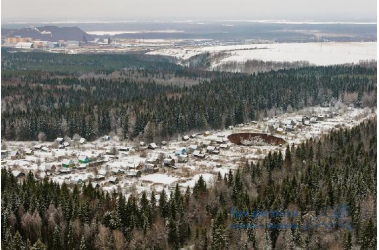
รูปที่ 6.6.12 หลุมยุบที่เกิดขึ้นพร้อมกับน้ำท่วมเหมือนโพแทชใต้ดิน (เหมืองซัลลิกรัม 2) เมื่อวันที่ 18 พฤศจิกายน 2014 มองเห็นเมืองและโรงงานผลิตยูโกลาที่มุมซ้ายมือด้านบนของภาพ (ที่มา fpv.perm.ru)
