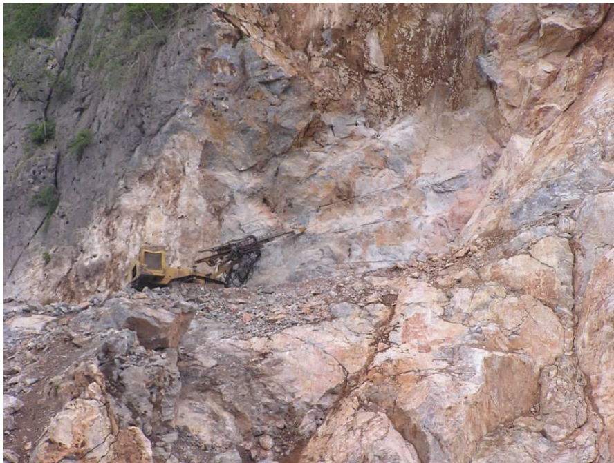
รูปที่ 6.4.5 การเจาะระเบิดตัดฐานเป็นรูปพัดโดยการระเบิดออกเป็นแผ่นๆในแนวตั้ง
