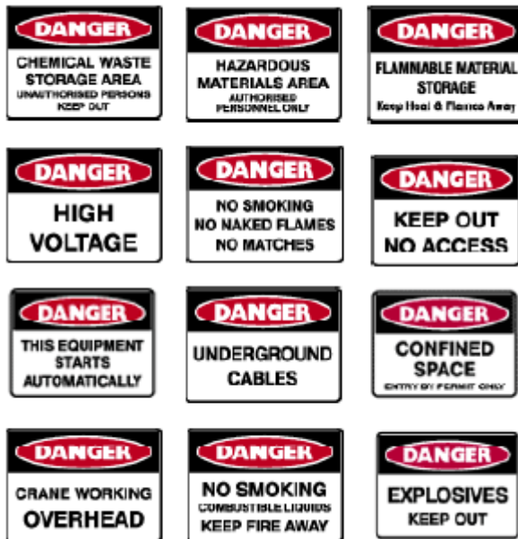
รูปที่ 1.7.1 ป้ายเครื่องหมายอันตราย
