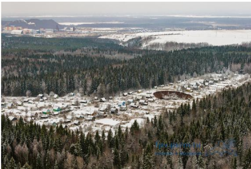
รูปที่ 1.8.15 หลุมยุบที่เกิดขึ้นพร้อมกับน้ำท่วมเมืองโพแทชไดคิน (เหมืองซัลลิกรัม 2) เมื่อวันที่ 18 พฤศจิกายน 2014 มองเห็นเหมืองและโรงงานผลิตอยู่ไกลที่มุมซ้ายมือด้านบนของภาพ(ที่มา fpv.perm.ru)
