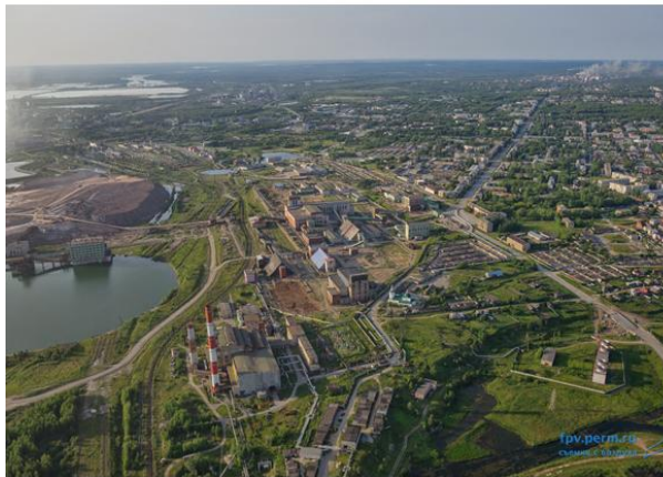
รูปที่ 1.8.5 หลุมยุบที่ 2 มองเห็นอยู่ใกล้กอง หางแร่ หลุมยุบที่ 2-3 มองเห็นอยู่ใกล้สถานี รถไฟอยู่ถัดจากหลุมยุบที่ 2-3 บริเวณ ตอนกลางของภาพคือพื้นที่เสี่ยงซึ่งคาดว่าจะ เกิดหลุมยุบแห่งใหม่เร็วขึ้น (ที่มา fpv.perm.ru)
