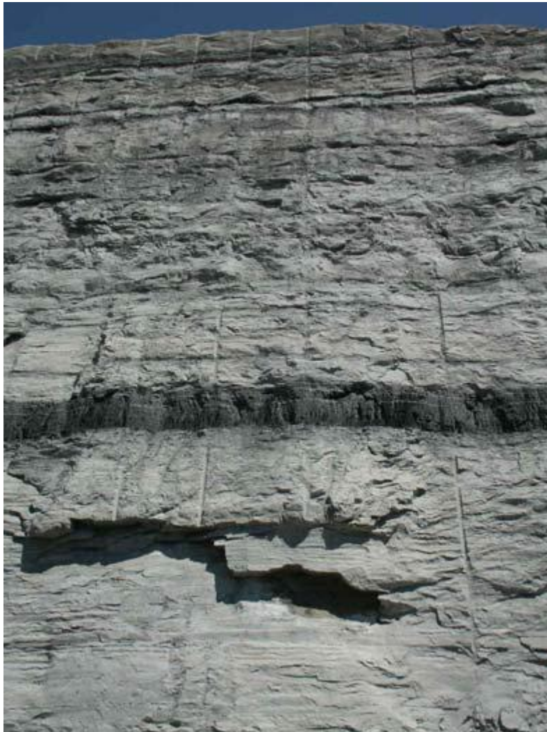
รูป 4.5.9 แสดงผลที่ได้จากการเจาะระเบิดแบบ pre-splitting เพื่อเพิ่มเสถียรภาพของหน้าเหมือง ถ่านหินในประเทศสหรัฐอเมริกา
