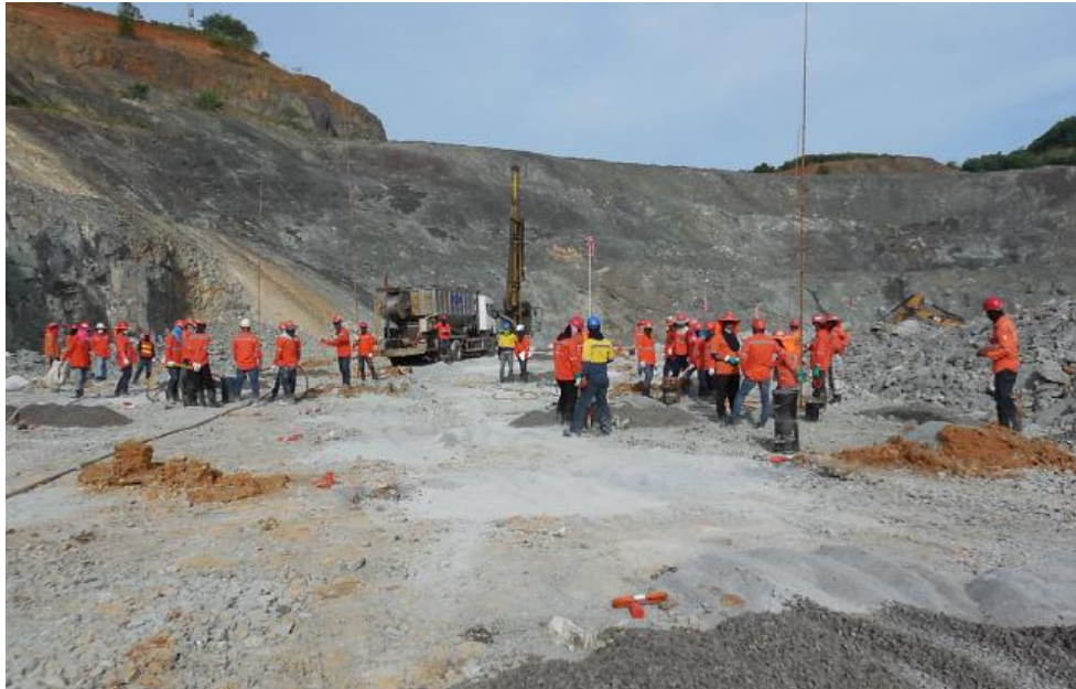
รูปที่ 5.5 บริษัทอัครา รีซอร์สเซส จำกัด (มหาชน) ใช้รถบรรทุกในการอัดระเบิดและใช้คนงานอัดระเบิดจำนวนมาก
