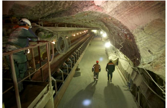
รูปที่ 4.1 แสดงการใช้สายพานลำเลียงใน เหมืองใต้ดิน (ที่มา en.wikipedia.org)
