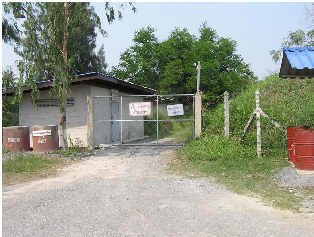
รูปที่ 7.9.1 คลังเก็บวัตถุระเบิดที่ไม่ทำคันดินด้านที่หันหน้าเข้าหาสำนักงาน
