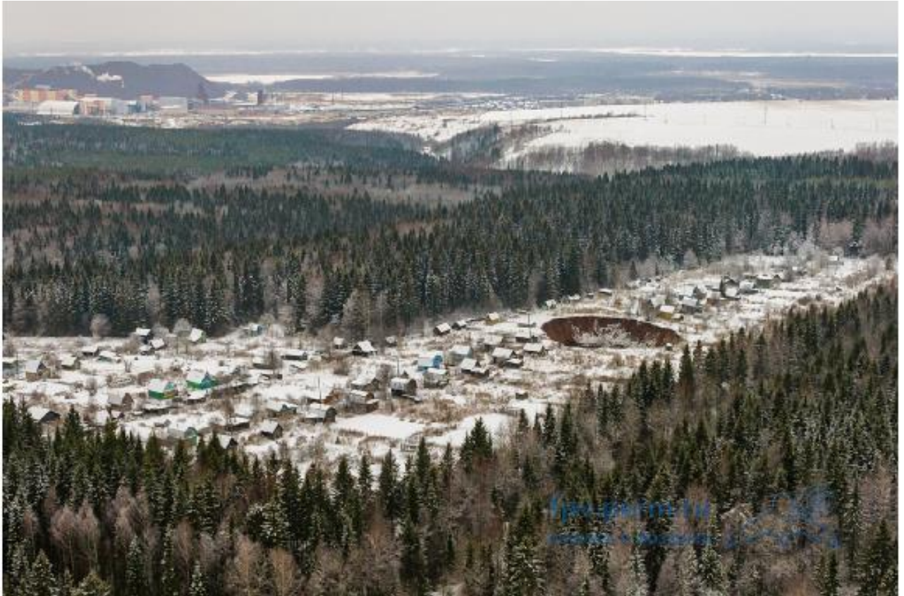
รูปที่ 7.6.12 หลุมยุบที่เกิดขึ้นพร้อมกับน้ำท่วมเหมือนโพแทชใต้ดิน (เหมืองซัลลิกรัม 2) เมื่อวันที่ 18 พฤศจิกายน 2014 มองเห็นเมืองและโรงงานผลิตยูเรียที่มุมซ้ายมือด้านบนของภาพ (ที่มา fpv.perm.ru)
