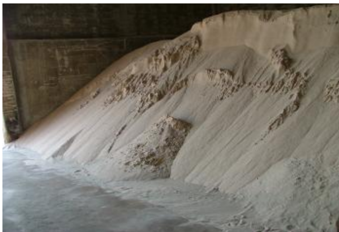
รูปที่ 3 ทราสล้างที่ผ่านการแต่งด้วยเครื่องมือชนิด Spiral เรียกว่า “ทรายแต่ง”
