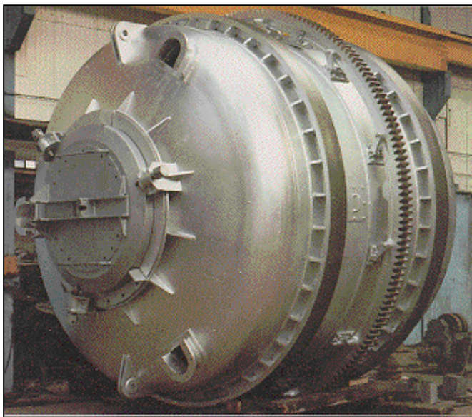
รูปที่ 3.7 เตาแบบหมุนสั้น (Short Rotary Furnace)
