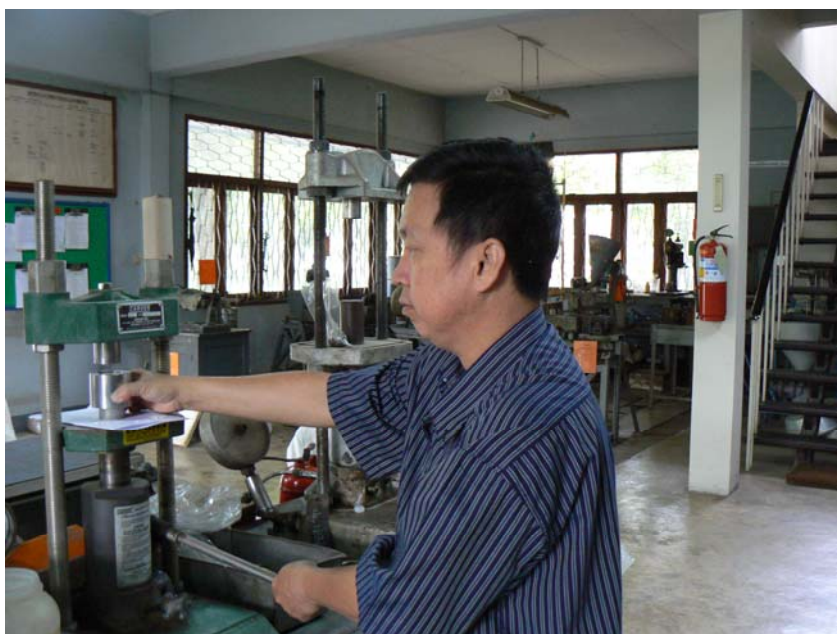
รูปที่ 6 การอัดแผ่นตัวอย่างบอลเคลย์ด้วยเครื่องอัดไฮดรอลิก
