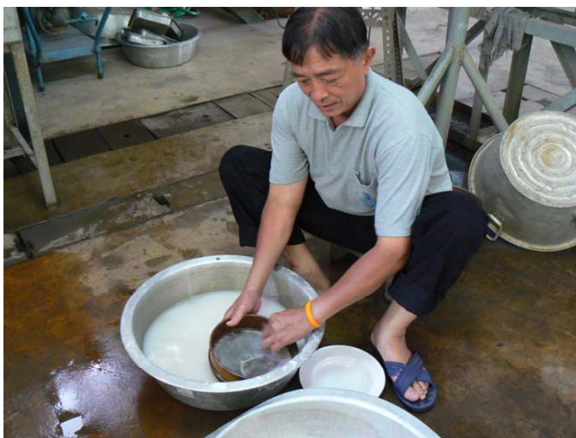
รูปที่ 5 การคัดขนาดบอลเคลย์ด้วยตะแกรงมาตรฐาน
