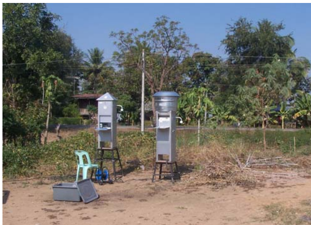
รูปที่ 3 แสดงการเก็บตัวอย่างฝุ่นละอองที่สถานีบ้านหนองแสง
