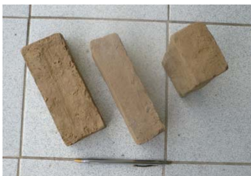
รูปที่ 15 นำเอาดินโคลนที่ได้มาหมักกับน้ำประมาณ 1 คืบ และใช้แบบในการขึ้นรูปอิฐ
