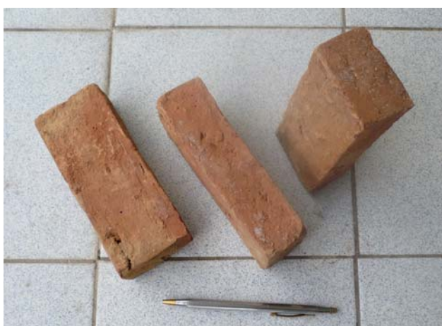
รูปที่ 19 อิฐที่ผลิตจากดินโคลนที่ได้จากการแต่งแร่
