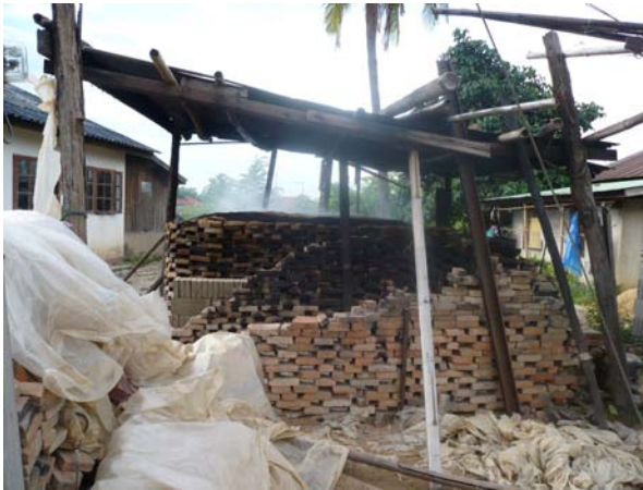
รูปที่ 12 ทำการเผาโดยใช้แกลบเป็นเชื้อเพลิง
