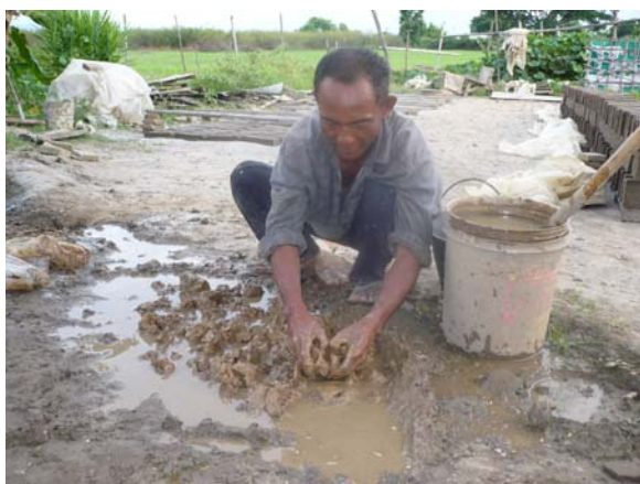
รูปที่ 15 นำเอาดินโคลนที่ได้มาหมักกับน้ำประมาณ 1 คืบ และใช้แบบในการขึ้นรูปอิฐ
