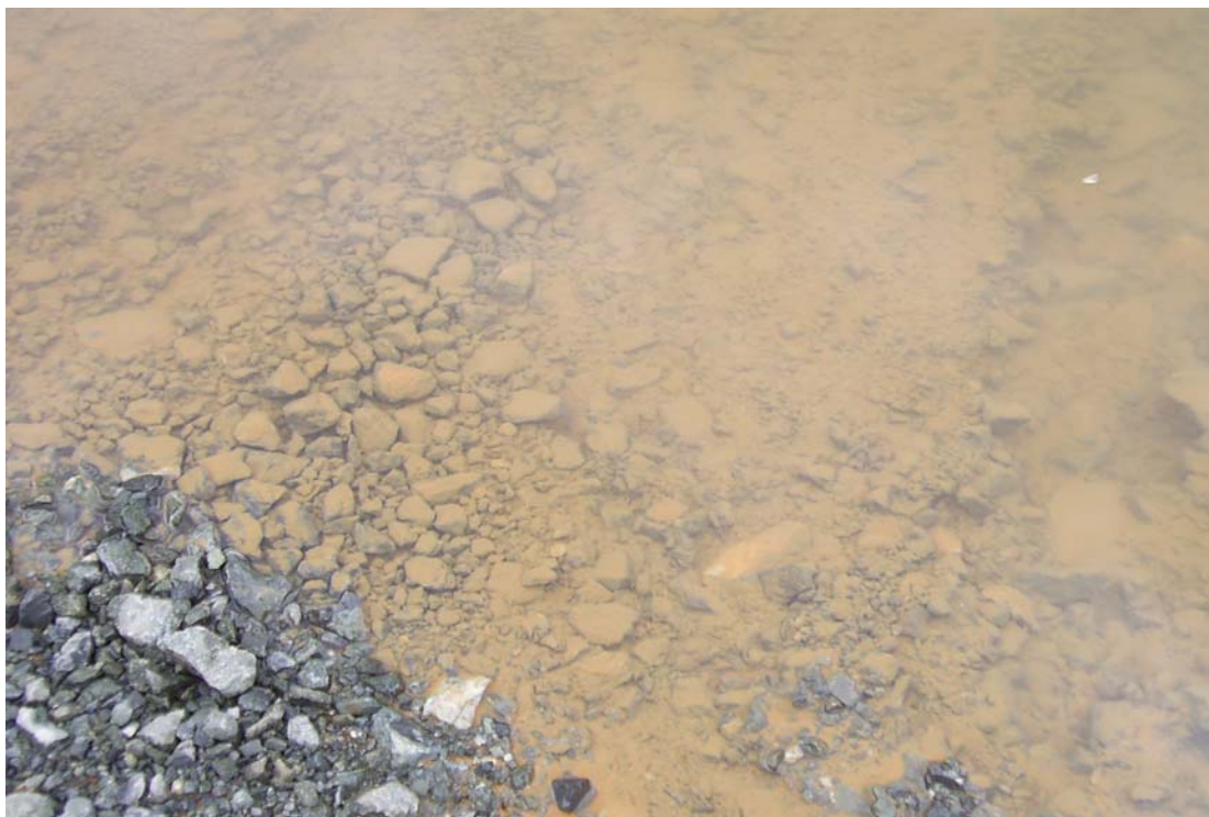
รูปที่ 14 ลักษณะการเกิด ออกซิเดชันมีการตกตะกอนของสารประกอบเหล็กเกิดทั่วไป
