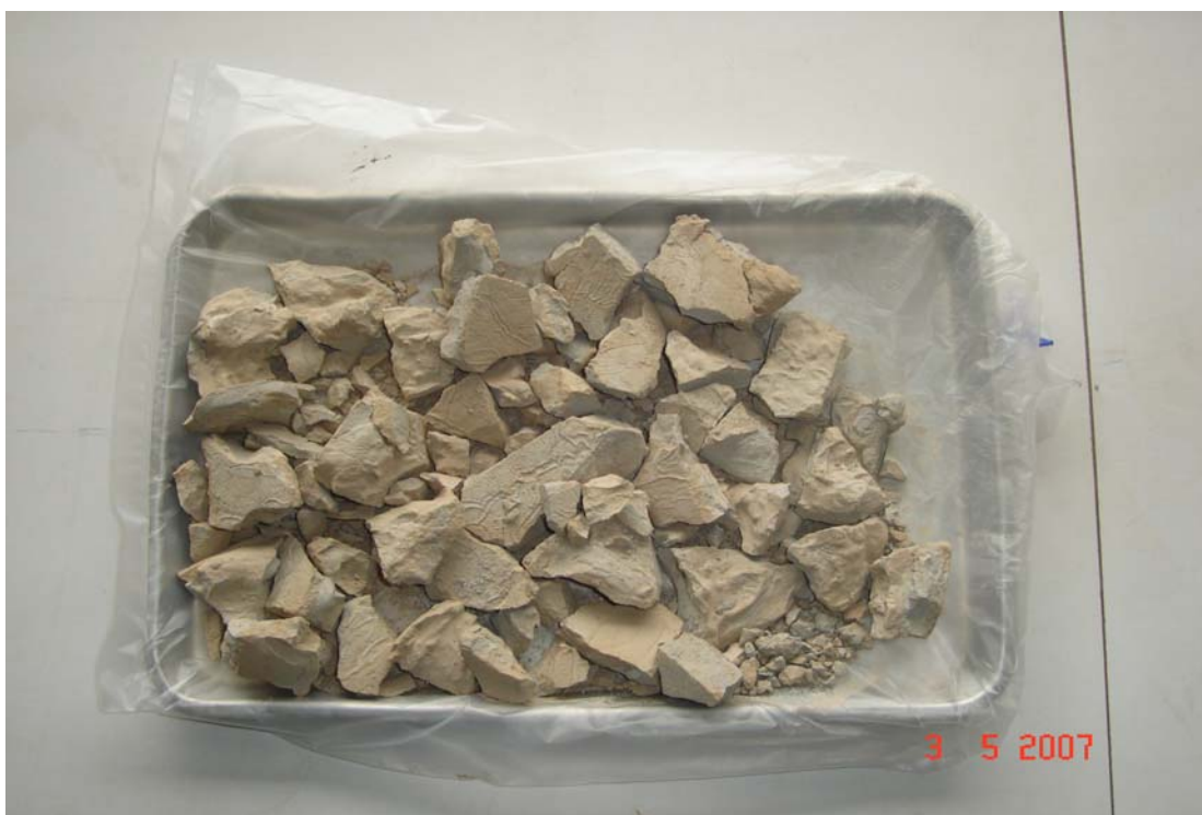
รูปที่ 12 กากตะกอนในบ่อTSF
