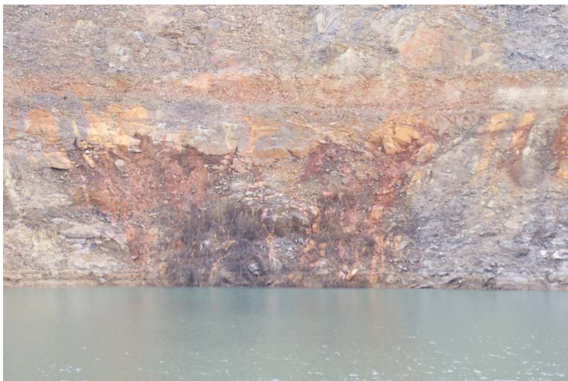
รูปที่ 15 ลักษณะการชะเอาอินเหล็ก แมงกานีส ลงสู่แหล่งน้ำ (จะเห็นคราบสีน้ำตาลของสารประกอบไฮดรอกไซด์ และสารประกอบออกไซด์ของอินดังกล่าว)
