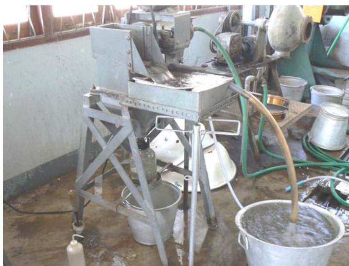
รูปที่ 6 จิกแยกแร่ (Jig) ขณะทำการทดลอง
