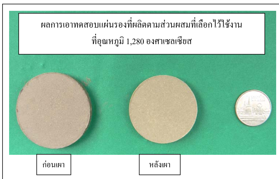
รูปที่ 13 ผลการเผาทดสอบเนื้อดินตามส่วนผสมที่เลือกไว้
