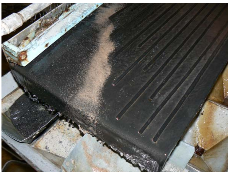
รูปที่ 9 แร่วูลแฟรม (สีดำ) ที่แยกจากสิ่งเจือปน (สีชมพูอ่อน) ด้วยการแต่งแยกแร่ด้วยโต๊ะสั่น
