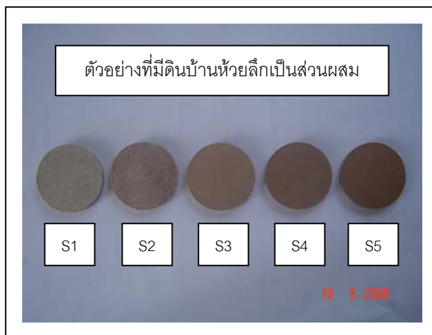
รูปที่ 3.5 แสดงสีหลังเผาของตัวอย่างที่มีดินบ้านห้วยลึกเป็นส่วนผสม
