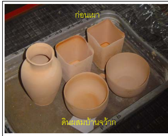
รูปที่ 4.18 แสดงชิ้นงานจากดินบ้านจัววกที่ขึ้นรูปด้วยวิธีหล่อแบบและเผาที่ 900^{\circ}\text{C}
